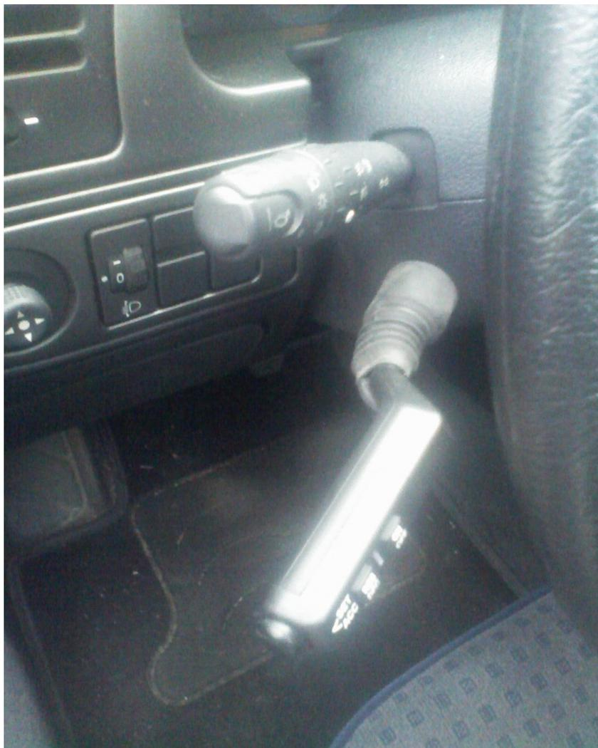
La commande CM19 est orientable grâce à 3 vis de réglages situées sur sa base.
